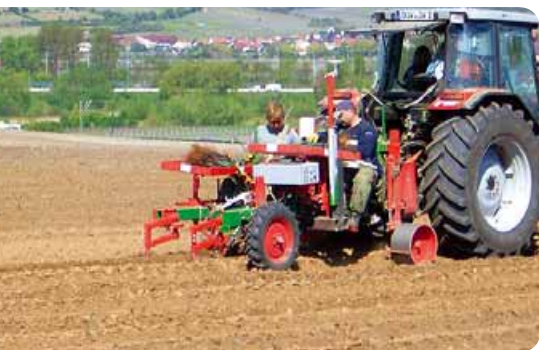
La trapiantatrice Wagner IPS-Drive, garantisce una precisione di impianto di \pm 1 cm a 4 km/ora di velocità e può piantare in entrambi i sensi di direzione. Essa è corredata di molti dispositivi di correzione d'assetto. Foto Wagner
