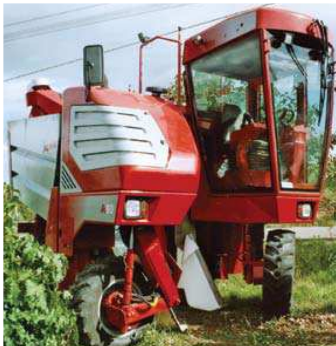
(C) - Prototipo di gruppo di raccolta ad aspi con asse verticale (CRF)
