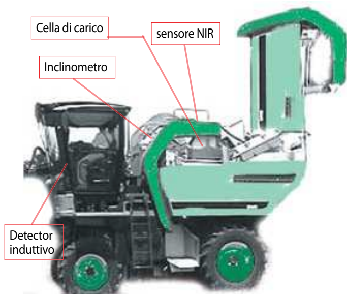
(A) - Vendemmiatrice con sistema NIR in grado di acquisire specifiche informazioni relative alla qualità e quantità dell'uva. In tal modo sarà possibile dividere il vendemmiato nei due cassoni laterali in funzione di parametri specifici (da Vieri, 2007 - Modificato)
